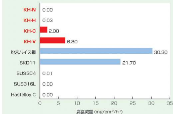
硝酸水溶液に対する耐腐食性 10wt% 硝酸水溶液 40℃×10 時間 浸漬
